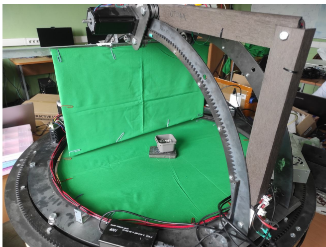
Рис. 8. Установка для съемки фотоизображений
